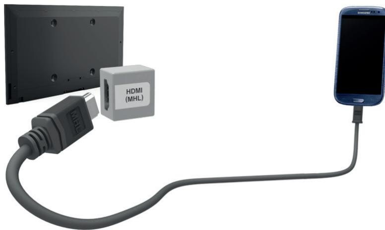
Una vez realizada la conexión, podrá seleccionar el dispositivo externo conectado usando el botón **SOURCE**.
