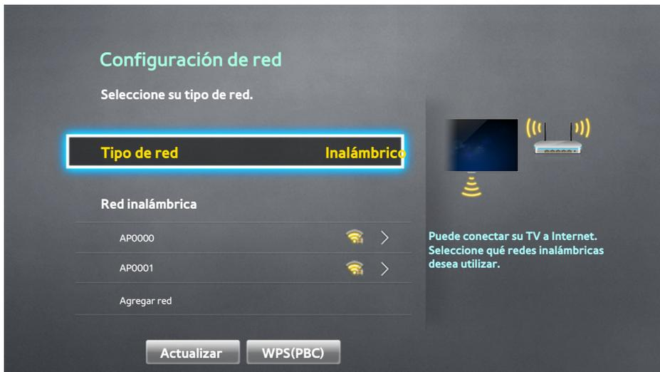
2. Seleccione una red (SSID). Si la red deseada no aparece en la lista, seleccione **Agregar red** e ingrese manualmente el SSID de la red.
