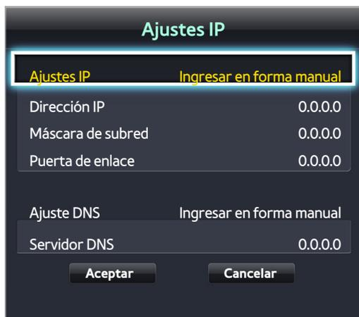
6. Pulse el botón
