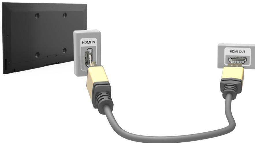
Una vez realizada la conexión, podrá seleccionar el dispositivo externo conectado usando el botón **SOURCE**.
